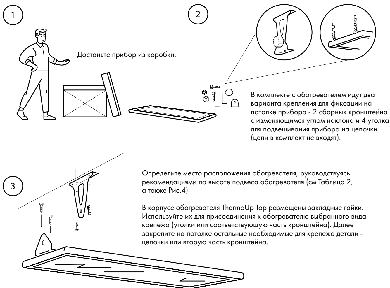
Рисунок 4. Монтаж обогревателя ThermoUp Top
